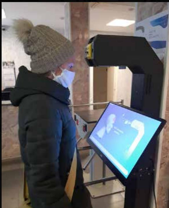
**С**оликамский магниевый завод (Пермский край) на центральной проходной и в заводоуправлении установил терминалы для автоматического бесконтактного измерения температуры тела «Промобот Термоконтроль». Они были изготовлены по заказу завода в кратчайшие сроки с целью исключить скопление людей при прохождении турникетов, которое возникает при работе с ручными тепловизорами.
